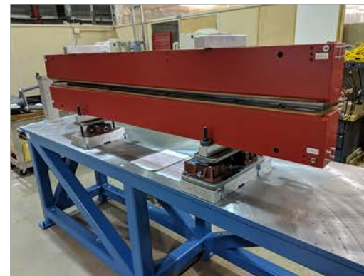
M1 Longitudinal-Gradient Dipole
