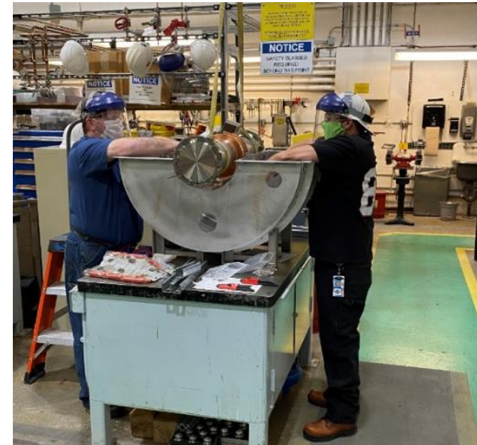
PAR harmonic test cavity being assembled
