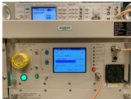
PAR 8 kW RF amplifier under test
